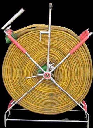
Dispone de dos ejes centrales, paralelos y de funcionamiento independiente, con sistema de freno. Con sistema de guía y centrado para asegurar el equilibrado de las mangueras en su recogida.
