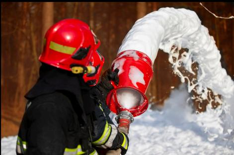
Debe tener rápida humectación, alta expansión, lento drenaje y muy poca corrosividad frente a los metales usados como son hierro, latón, aluminio, magnesio, etc...
